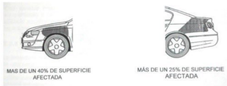
Imagen 6: Nivel de daño: Fuerte
