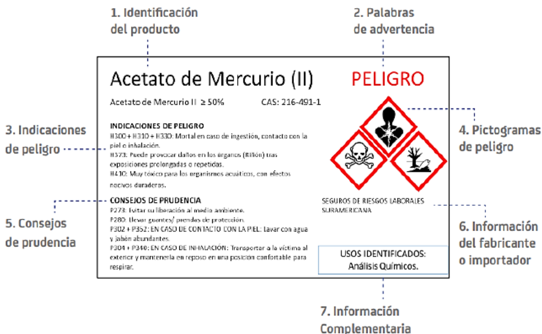
Imagen 8. Rotulación para depósitos de residuos peligrosos.
