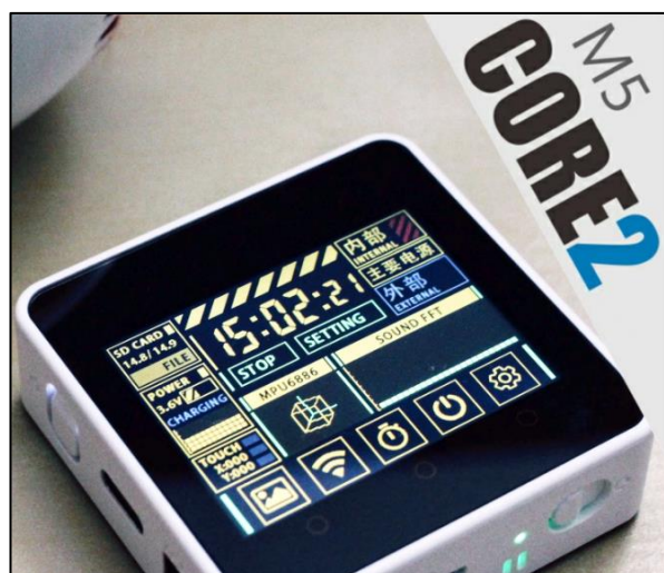
Figura 14. Módulo de desarrollo M5Stack Core 2. Elaborado por: Gavilanes Alex, 2022.
