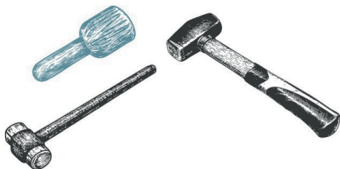
Figura 21. Tipos de combos empleados en obra
