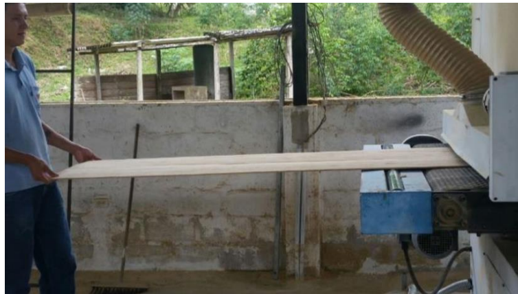
Figura 16: Proceso de lijado
