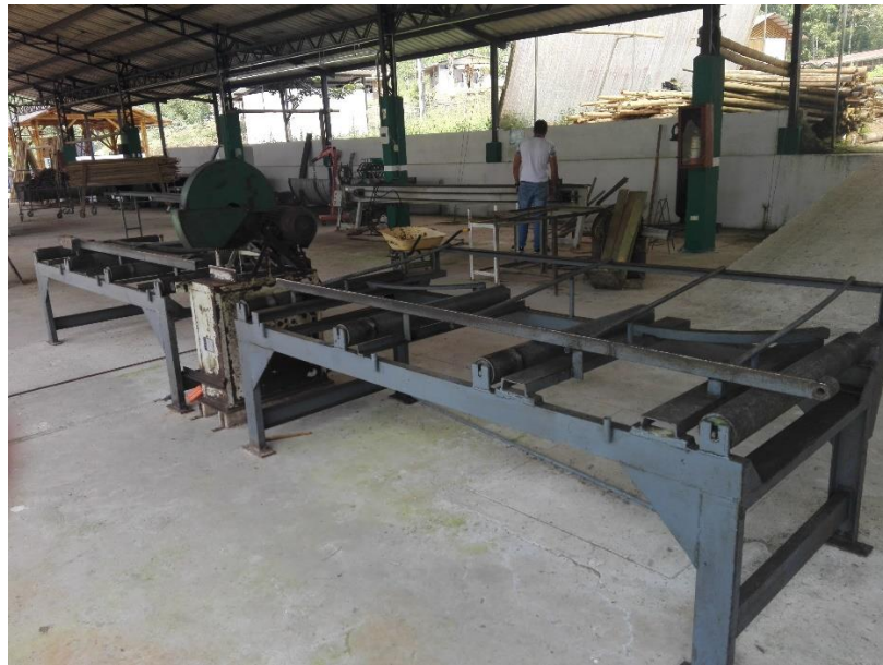
Figura 4: Proceso de despuntado
