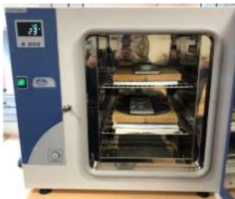
Figura 37 Muestra de la hoja del verde y el papel ecológico con peso encima en la estufa JP-Selecta 2000250.
