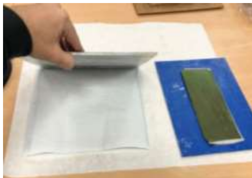
Figura 36 Placas PC con muestra de las hojas del verde y el papel ecológico, cubriéndolo con el papel de mano.
