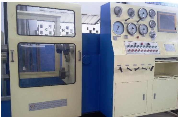
Imagen 14. Banco para pruebas hidrostáticas Modelo YFB Fuente: MISSIONPETROLEUM S.A
