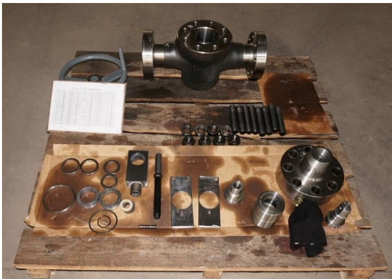
Imagen 13. Componentes de la válvula de compuerta modelo FC
