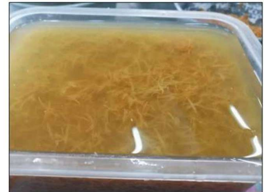
Figura 9 Fibra de zanahoria remojada en cal hidráulica por 24 horas
