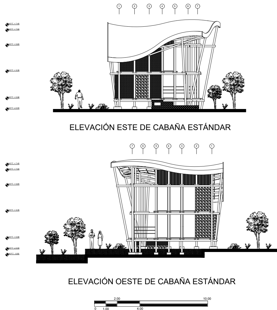
Figura 67. Elevaciones este y oeste cabaña estándar
