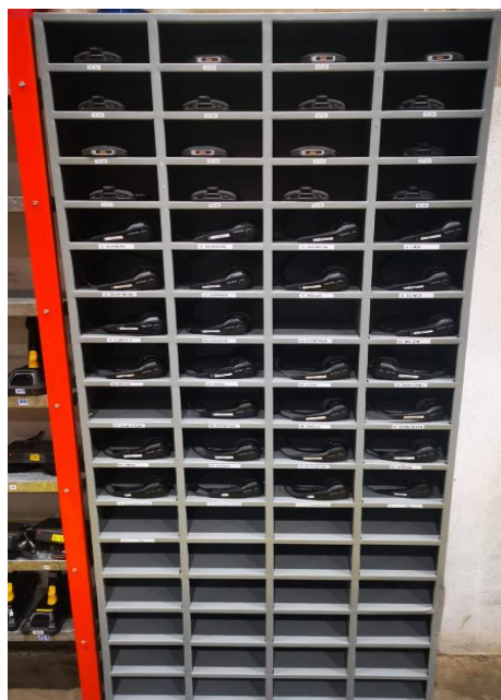
Figura No. 37. Estación de carga de baterías HS3100.
