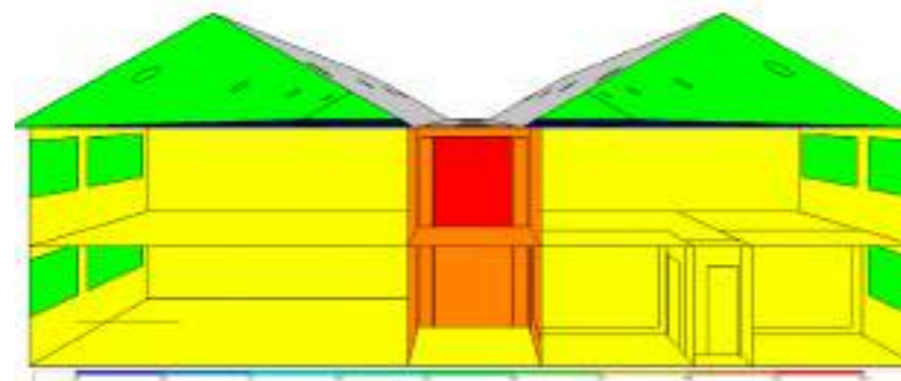
Figura4O8. Incidencia solar corte transversal estado actual - invierno 10:00am.
