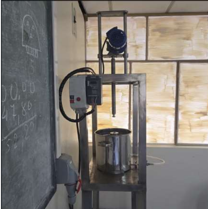
Imagen 10: Instalación eléctrica en la prensa de extracción de aceite. Elaborado por: Delgado, Carlos (2025).
