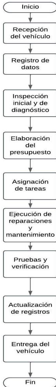
Gráfico 2. Reparación y mantenimiento de vehículos Elaborado por: Oñate, Byron (2024).
