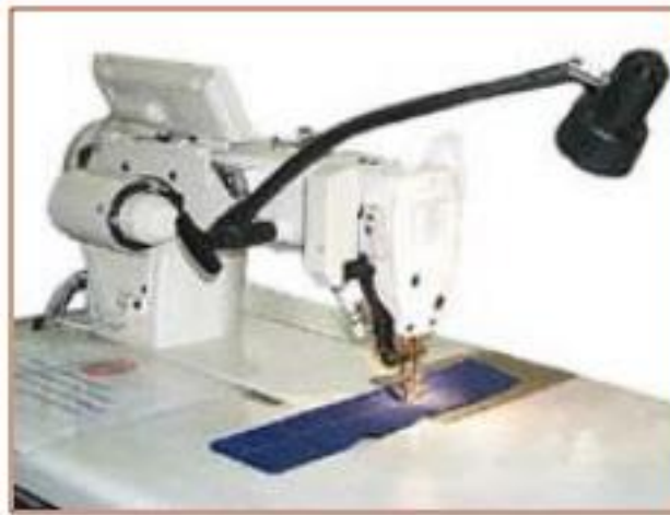
Ilustración N° 4: Iluminación de maquinaria textil ( htt6 )
