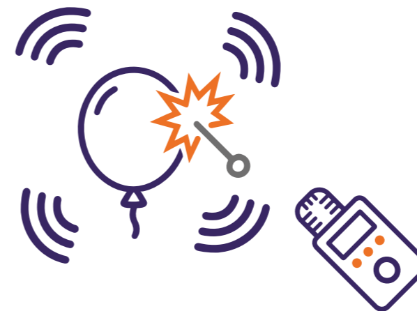
Figura 29. Método de respuesta impulsiva
