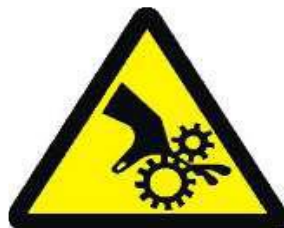
Imagen N°7 Señal de riesgo mecánico
