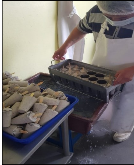
Figura 11: Desmoldado de los helados. Fuente: Helados El Sam
