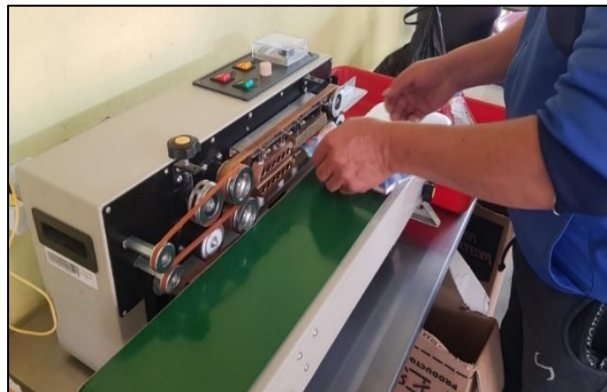
Figura 12: Sellado semiautomático de los helados. Fuente: Helados El Sam
