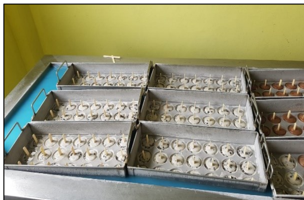
Figura 10: Abatimiento de temperatura. Fuente: Helados El Sam
