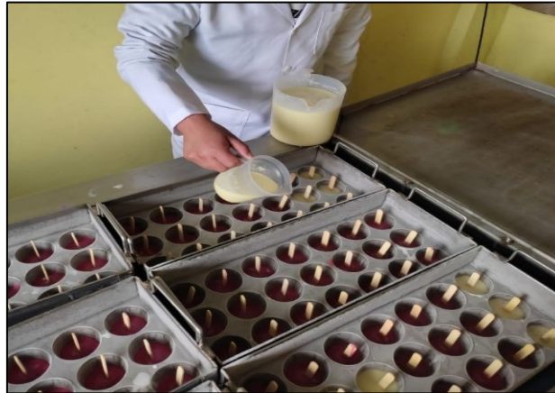
Figura 9: Colocación de la mezcla en los moldes. Fuente: Helados El Sam
