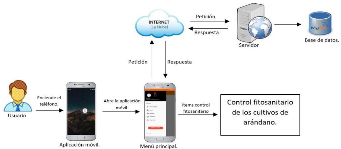
Figura 3: Esquema general de la aplicación móvil.
