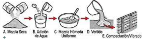
Figura 12. Preparación mezcla hormigón
