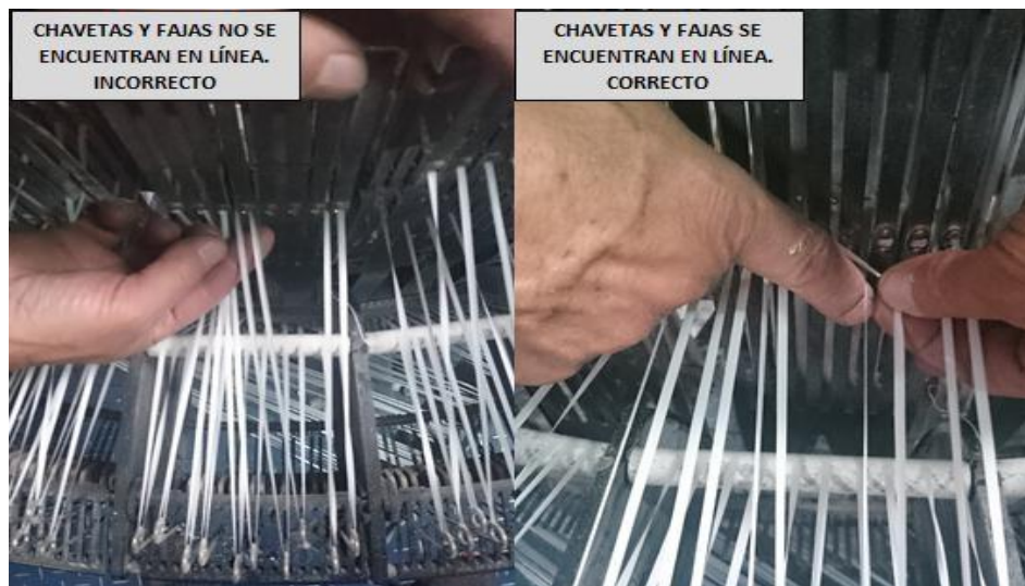
Fig. 10. Alineación correcta de chavetas y fajas.
