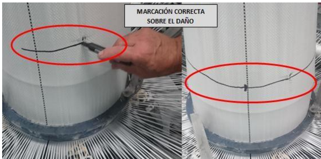
Fig. 25. Forma correcta de marcación sobre el daño.
