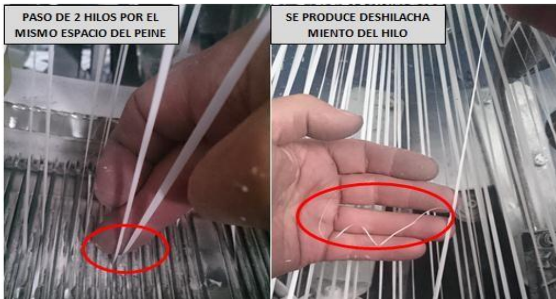
Fig. 11. Falla por pasar 2 hilos en el peine.
