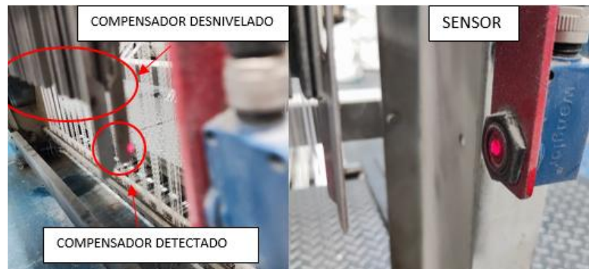
Fig. 6. Detección de compensador desnivelado.
