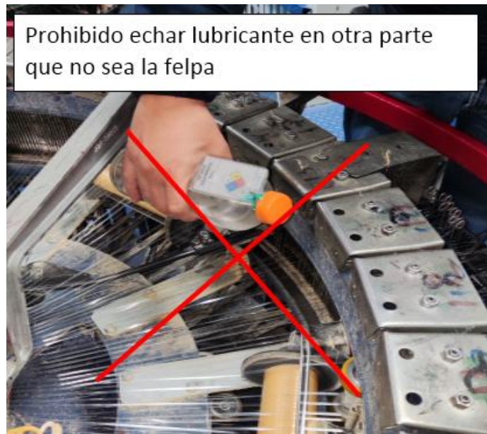
Fig. 24. Prohibido echar lubricante en otra parte del telar.
