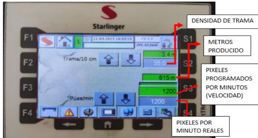
Fig. 15. Especificaciones de densidad reticular de trama.
