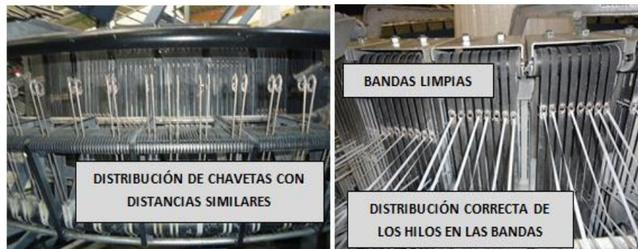
Fig. 29. Correcta distribución de hilos
