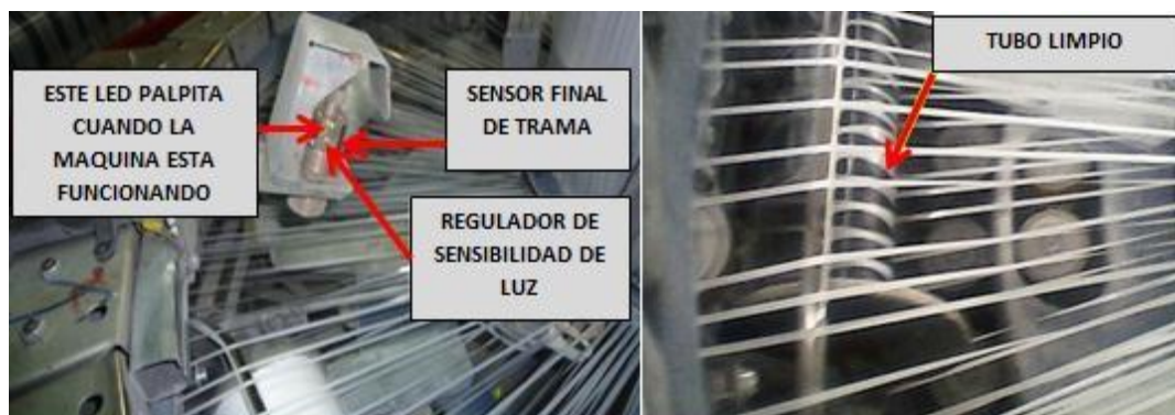
Fig. 18. Sensor final de trama
