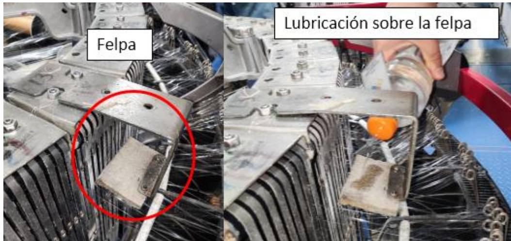
Fig. 23. Lubricación de felpa.
