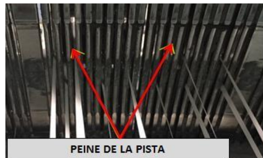
Fig. 30. Distancia correcta entre hilos
