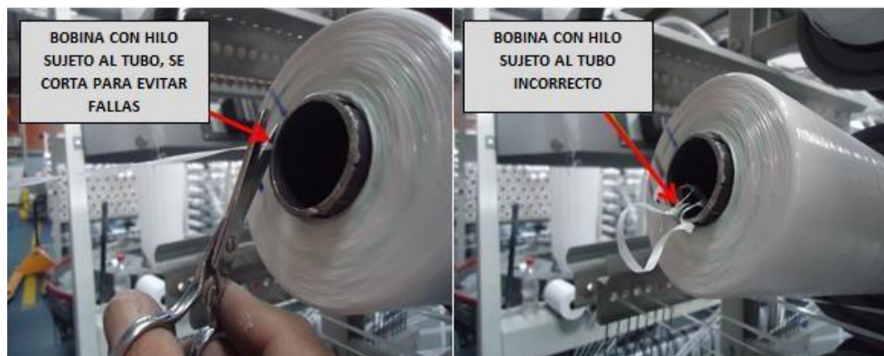
Fig. 21. Verificación que no existan colas en las bobinas
