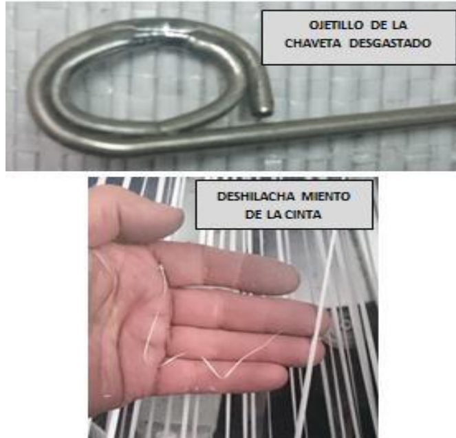
Fig. 9. Falla por objetillo desgastado.
