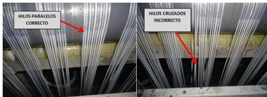
Fig. 33. Posición correcta de los hilos
