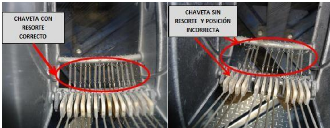
Fig. 8. Chaveta en óptimas condiciones.
