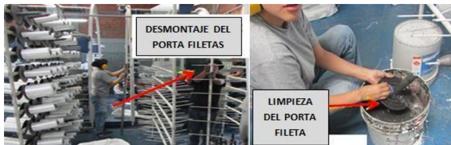
Fig. 5. Desmontaje del porta filetas
