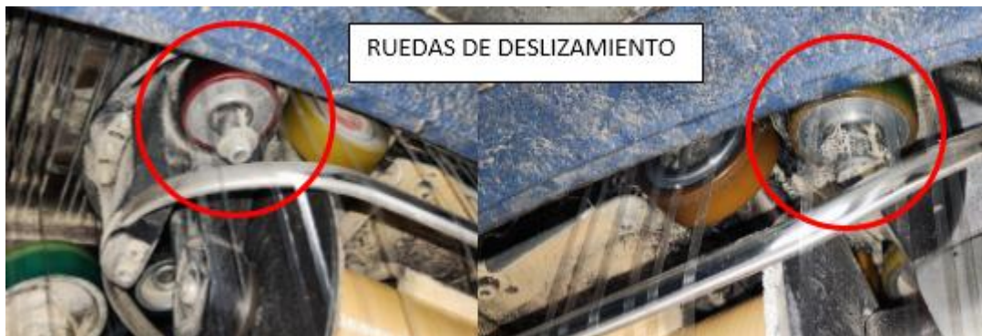
Fig. 21. Ruedas de deslizamiento.
