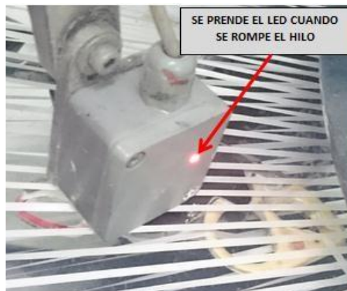
Fig. 18. Detección de LED por hilo roto.
