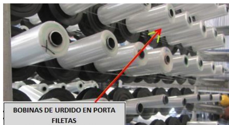
Fig. 20. Colocación de nuevas bobinas
