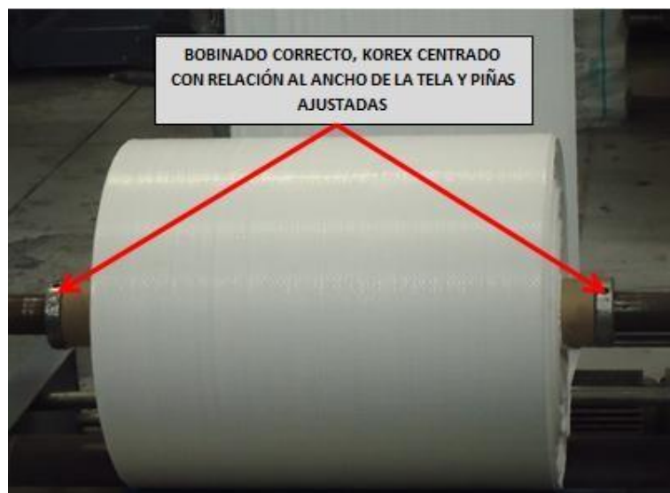
Fig. 15. Especificaciones del montaje del rollo
