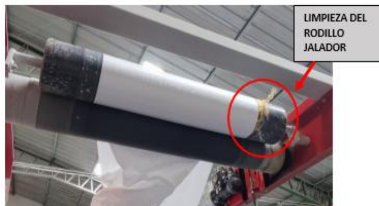
Fig. 13. Limpieza del rodillo jalador
