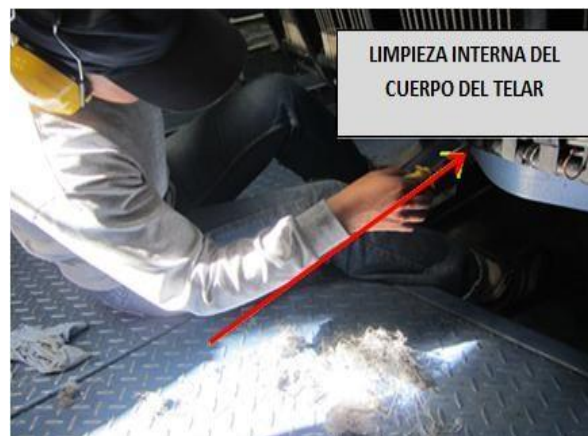
Fig. 8. Limpieza interna del telar
