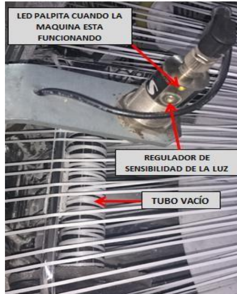
Fig. 18. Detección de LED por bobina sin hilo.
