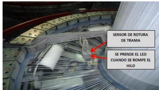
Fig. 17. Sensor de rotura de trama
