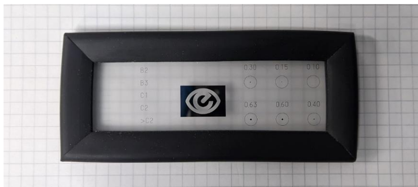
Fotografía de la herramienta para la medición de rayas y poros
