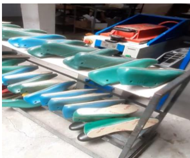
Imagen 10. Proceso de armado, preparación de la horma con la platilla de armado
