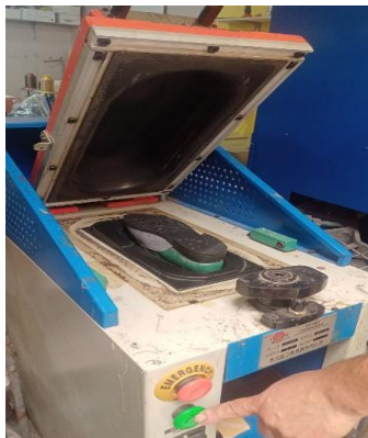
Imagen 12. Prensado al vacío con calor para fijar suelas
