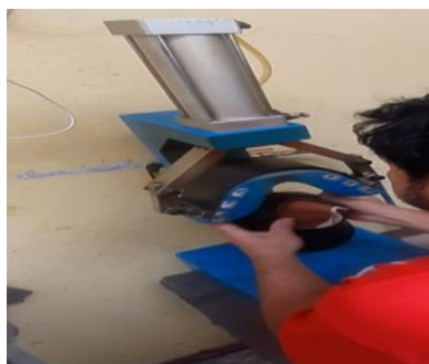
Imagen 9. Proceso de armado, máquina de armado, ensambladora de puntas y talones
