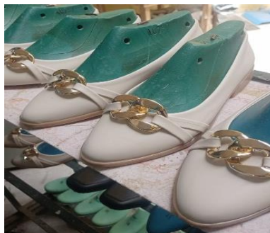
Imagen 13. Proceso de pegado, Reposo del calzado para secar la goma
