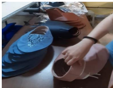
Imagen 8. Proceso de armado, preparación de las piezas aparadas
