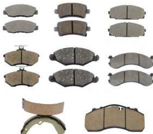
Gráfico 13. Tipos de pastillas de freno
