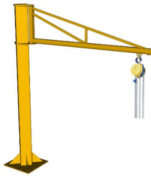
Imagen No. 5: Grúa tipo pescante con polipasto manual.
