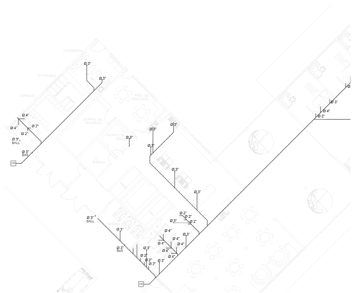
Figura 78. Plano de instalaciones sanitarias
