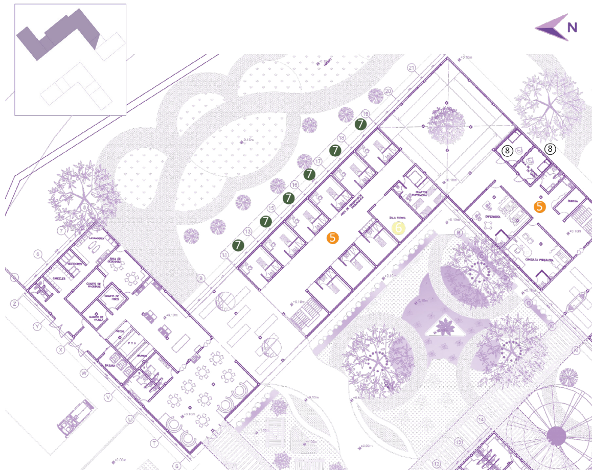
Figura 56. Edificación 2 - Sección 1, Planta Baja
