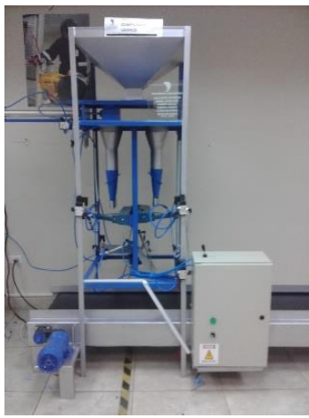
Figura 1. Máquina dosificadora de granos
