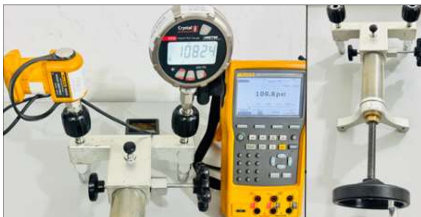
Figura 10. Comprobación hermeticidad del sistema.
