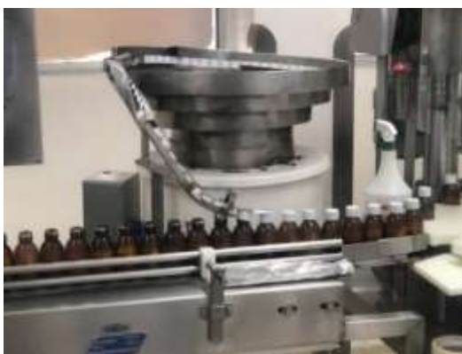
Figura 15 Máquina de colocación de tapas.
