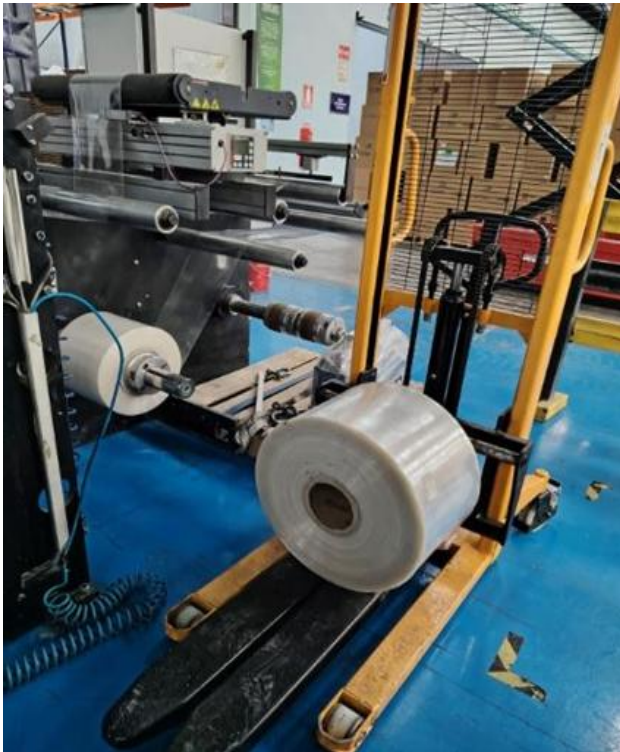
Figura No. 14: Incorporación de coche hidráulico.
