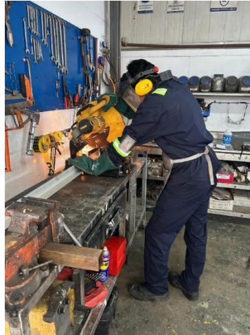
Figura No. 54: Proceso de corte material de acero inoxidable 304 tipo L mediante trozadora.
