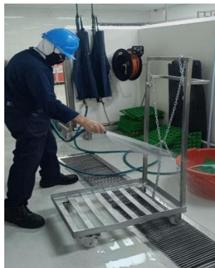
Figura No. 79: Limpieza del coche de acero inoxidable 304.
