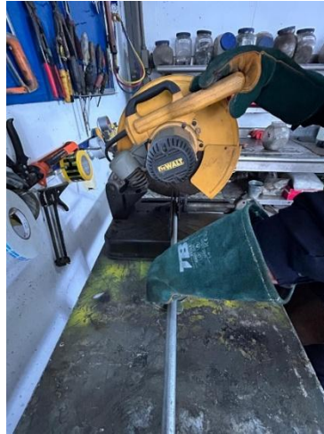
Figura No. 57: Proceso de corte material tubo redondo bocín de acero inoxidable 304 mediante trozadora.
