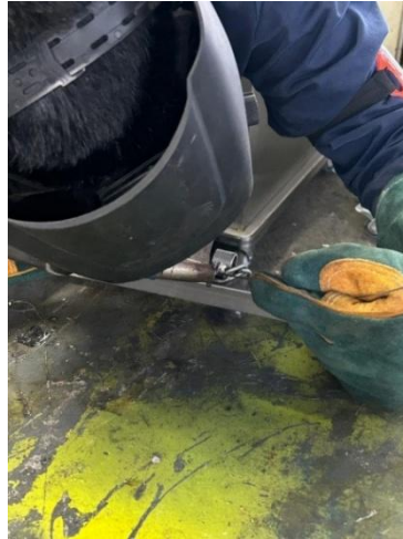
Figura No. 63: Ensamble de bocín y cadena de sujeción en el pasamanos del coche de acero inoxidable 304.
