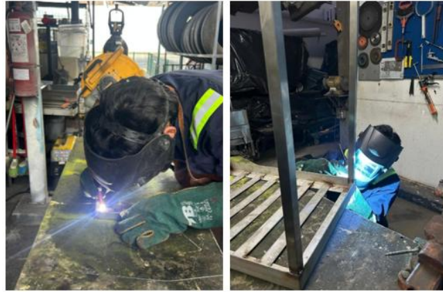
Figura No. 61: Ensamble de tubo cuadrado en la base del coche de acero inoxidable 304.
