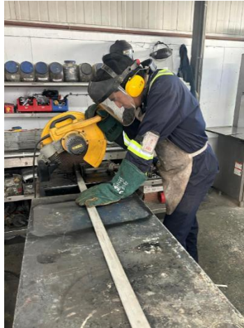
Figura No. 55: Proceso de corte material platina de acero inoxidable 304 mediante trozadora.
