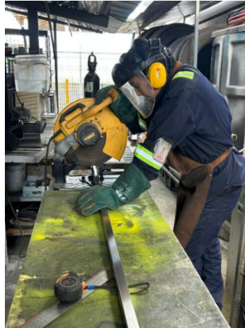
Figura No. 56: Proceso de corte material tubo cuadrado de acero inoxidable 304 mediante trozadora.
