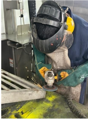
Figura No. 64: Proceso de desbaste con amoladora con disco mil lijas #180.
