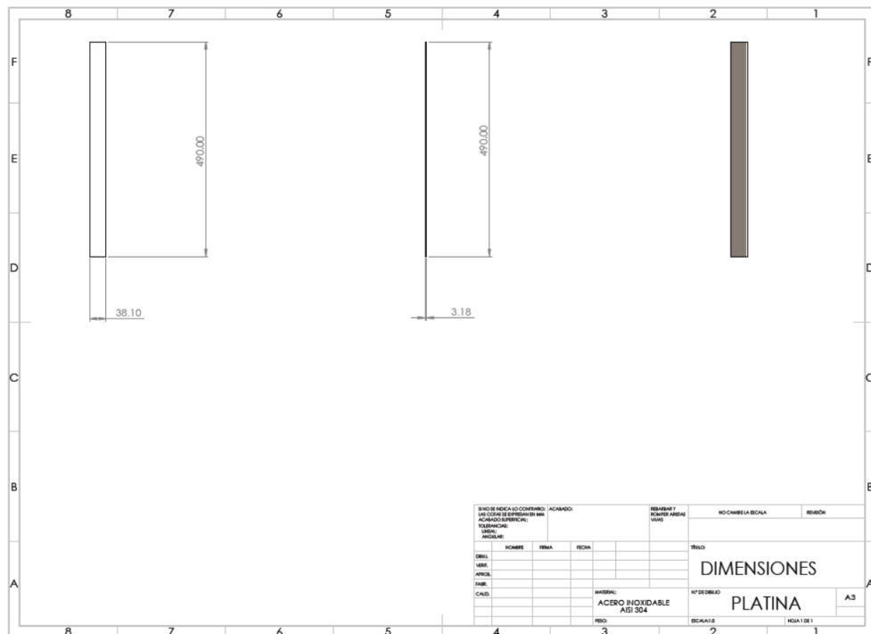
Figura No. 39: Dimensiones platina acero inoxidable 304.
