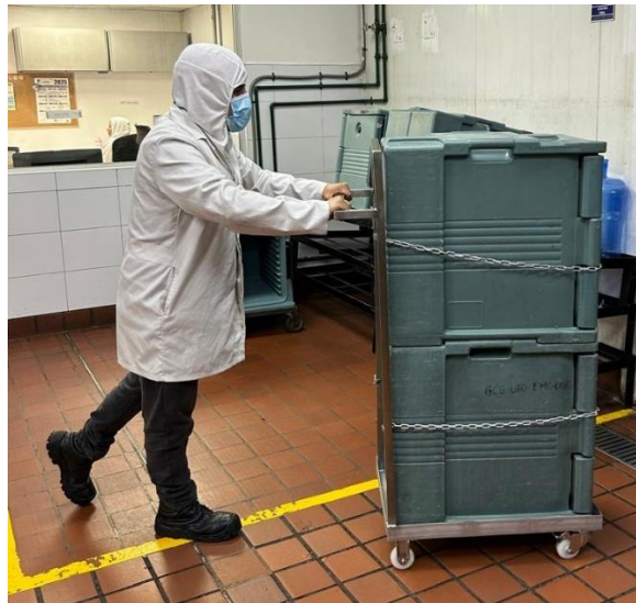
Figura No. 66: Coche de acero inoxidable AISI 304 para el transporte de cambros.
