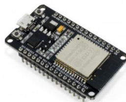
Figura 21: Placa Esp32 Fuente: naylampmechatronics [23].
