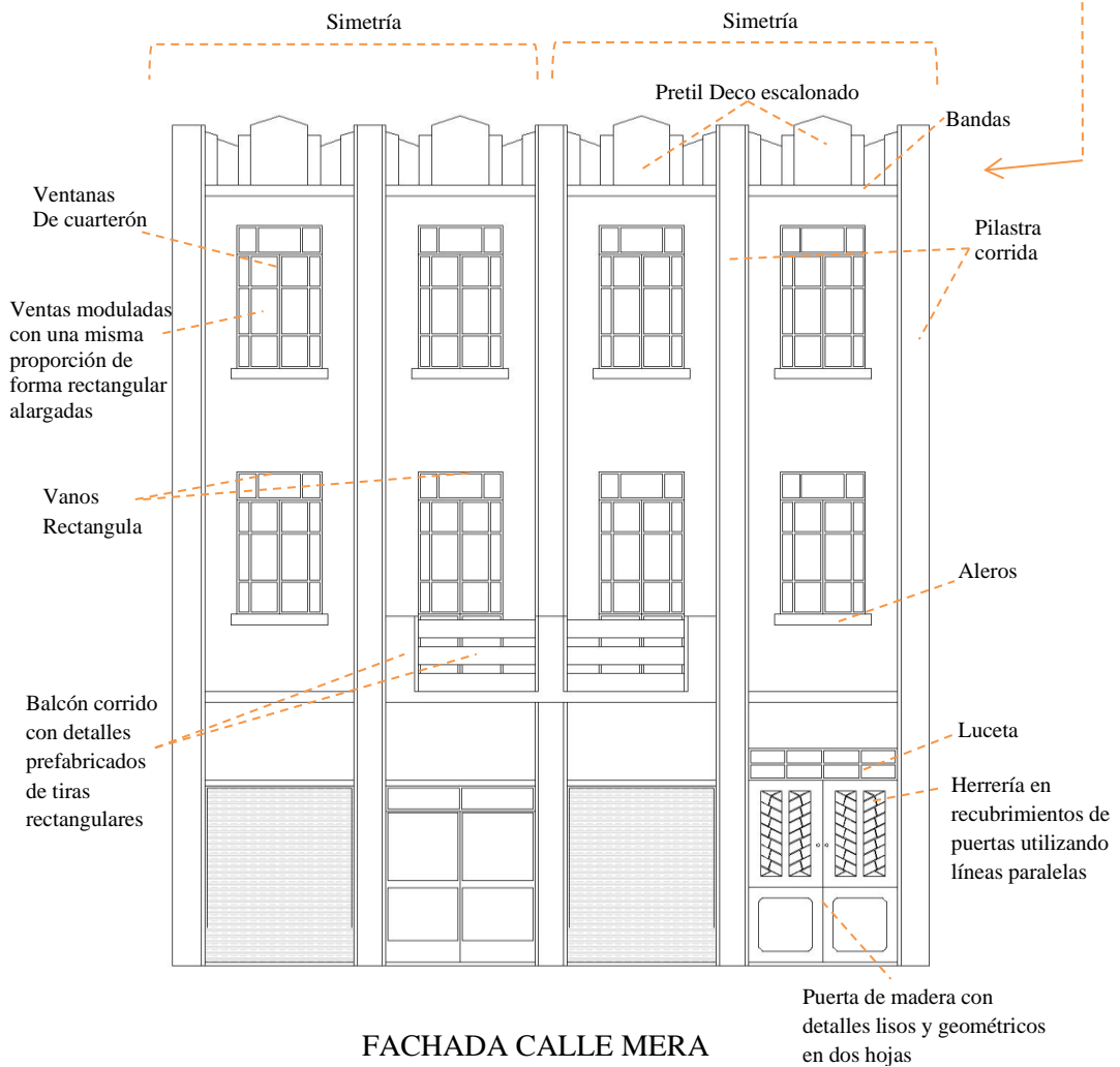
Gráfico 79. Edificación A43D con sus elementos formales y figurativos Art Deco Ambato Elaborado por: Gutiérrez, F. (2020)
