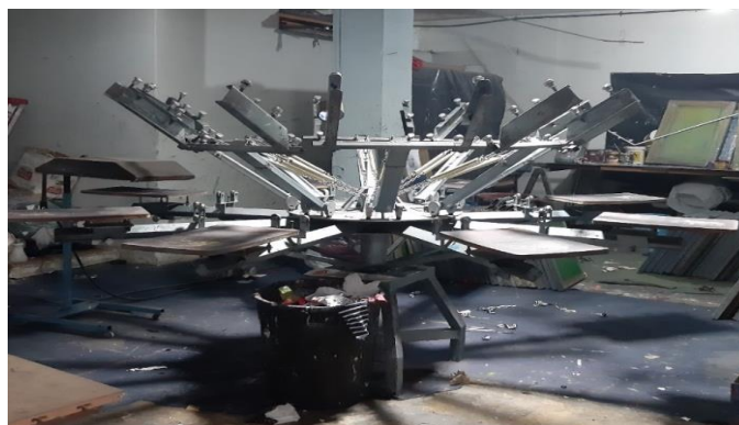
Figura No. 28: Pulpo de 8 estaciones para operación de estampado.
