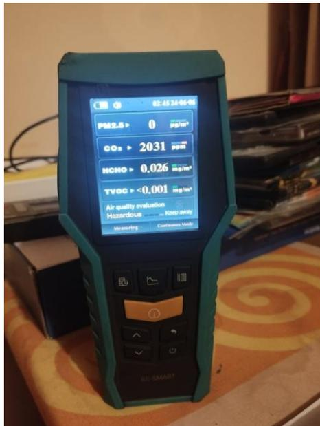
**Imagen 4.** BLATN Monitor de calidad del aire dióxido de carbono PM2.5 PM10 formaldehído probador de temperatura y humedad para interiores y exteriores, detector de contaminación del aire con alarma de audio.
