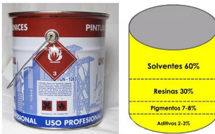
**Imagen 2.** Volumen de cada compuesto incluido en la mezcla de la pintura industrial.
