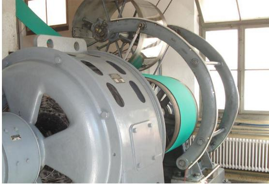
**Nota:** Esta imagen se identifica una banda plana, sus tipos de materiales y aplicación en potencia generada por el elemento tractor, fuente (BELTECH, 2024).
