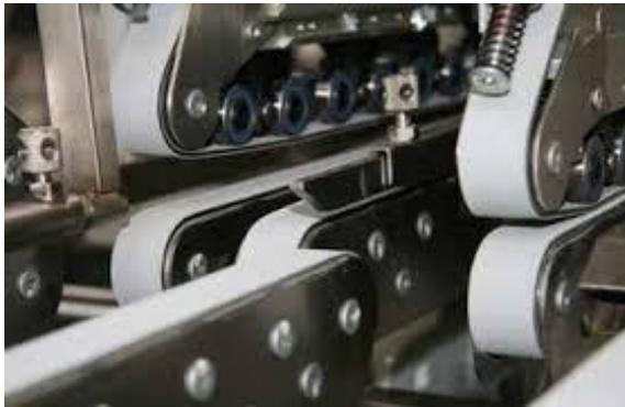
**Nota:** Esta imagen se identifica una banda plana, sus tipos de materiales y aplicación en arrastre, fuente (BELTECH, 2024).
