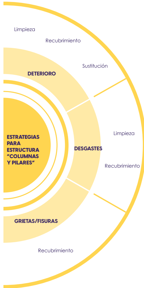
Figura 16. Resumen de Intervenciones. Estructura "Columnas y Pilares".
