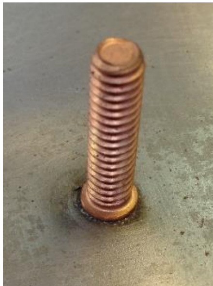
Figura 557 Soldadura de espárragos. Fuente: CGM (2016).
