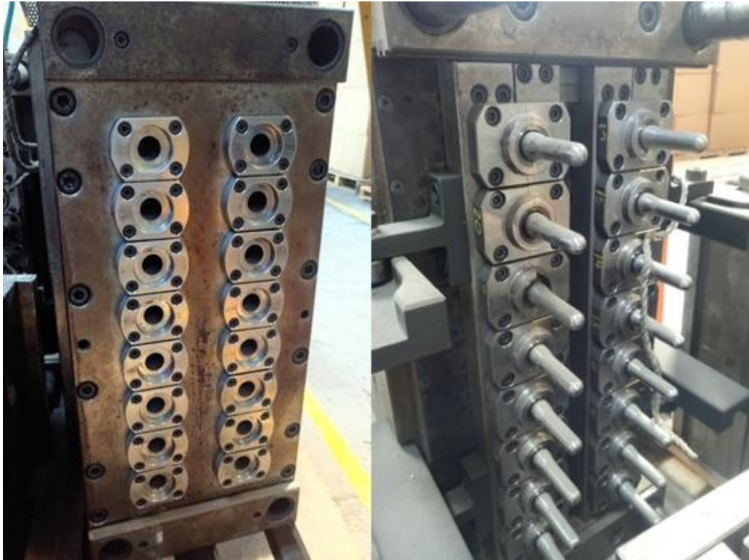
Figura N° 25: Molde para inyección de Preformas Fuente: INSOPLAST Elaborado por: El Investigador
