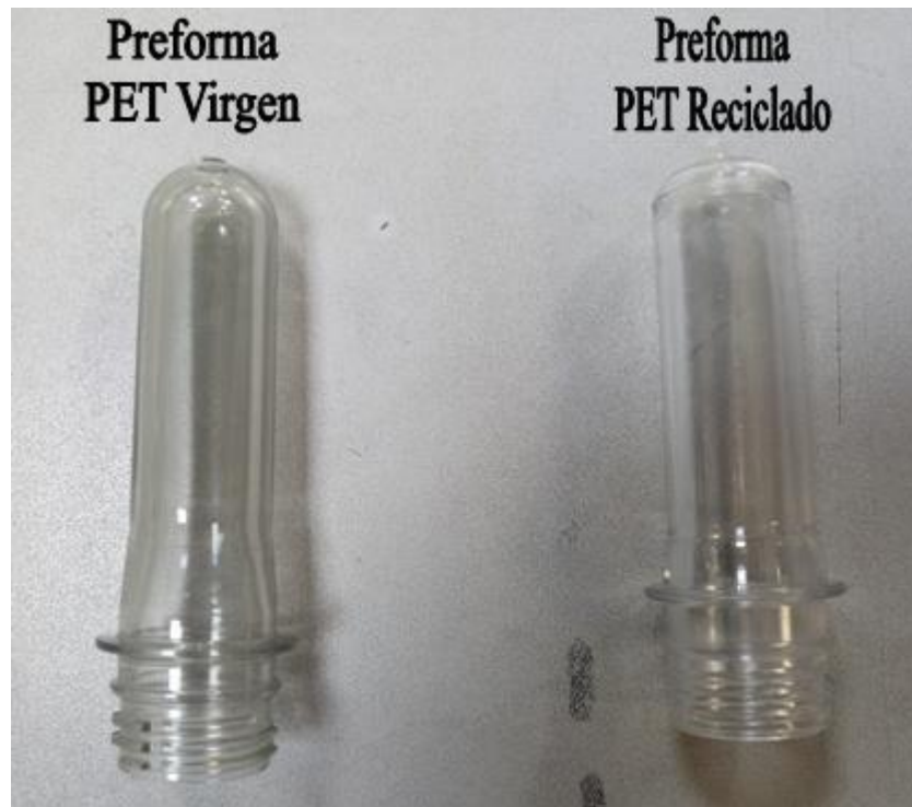
Figura N° 24: Preforma reciclada y en material Virgen Fuente: INSOPLAST Elaborado por: El Investigador
