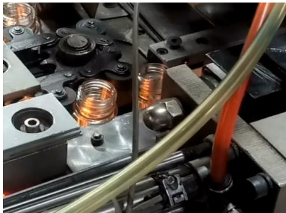
Figura N° 21: Toma de Preforma y colocación en molde Fuente: INSOPLAST Elaborado por: El Investigador
