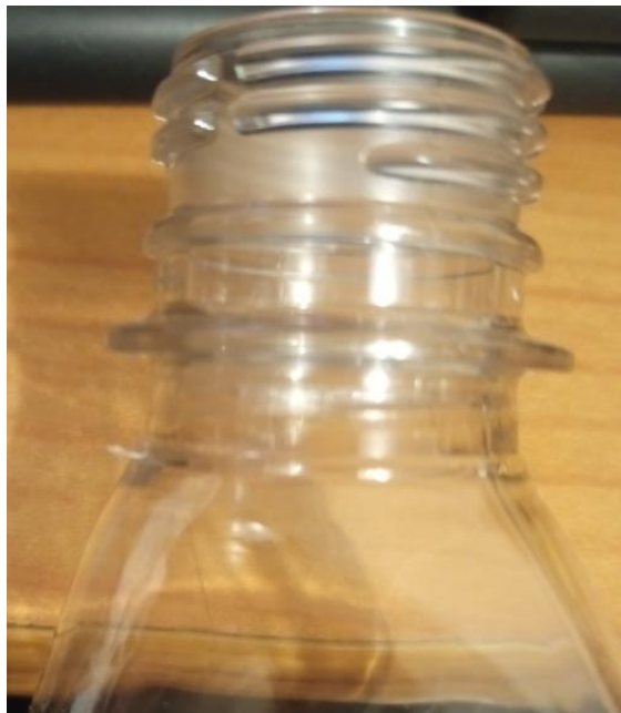
Figura N° 28: Rebabas en el cuello del envase Fuente: INSOPLAST Elaborado por: El Investigador
