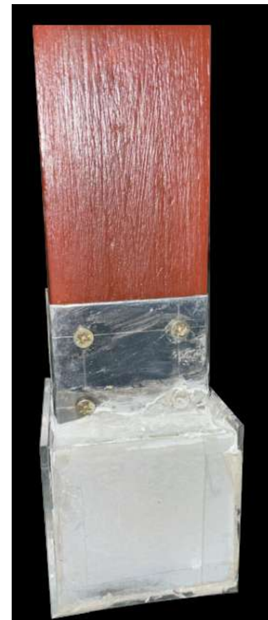
Figura 24. Entalladura en el eje del soporte y se fija por pasadores
