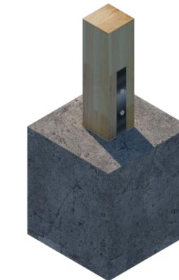
006 Poste de madera laminada sección 140mm x 140mm
