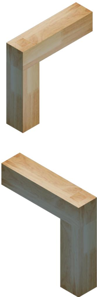
006 Poste de madera laminada sección 140mm x 140mm.
