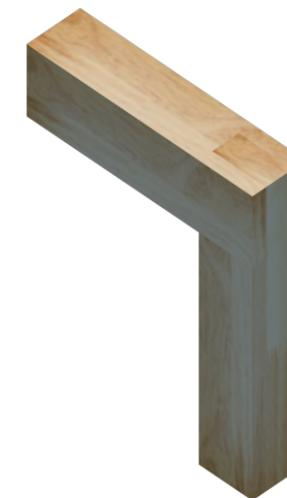
**006** Poste de madera laminada sección 140mm x 140mm.
