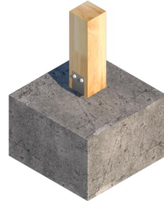
006 Poste de madera laminada sección 140mm x 140mm.
