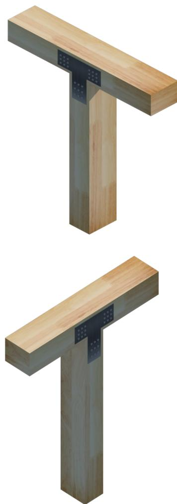
006 Poste de madera laminada sección 140mm x 140mm
