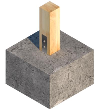
006 Poste de madera laminada sección 140mm x 140mm.
