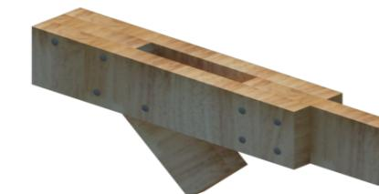
037 Sección de madera para unión entre riostra y viga. Espesor 40mm x 140mm.
