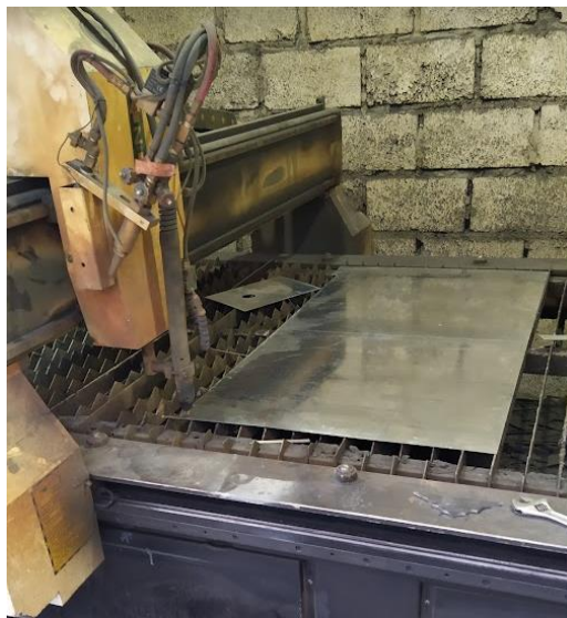
Imagen 10 Corte de plasma para tol galvanizado
