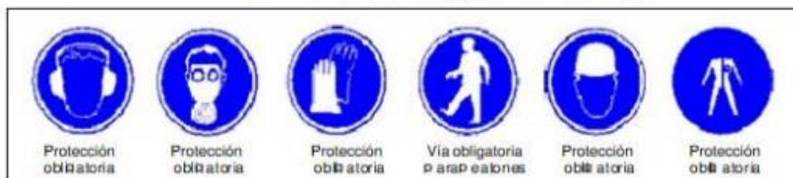
Fig. 2. Señales de obligación (protección)
