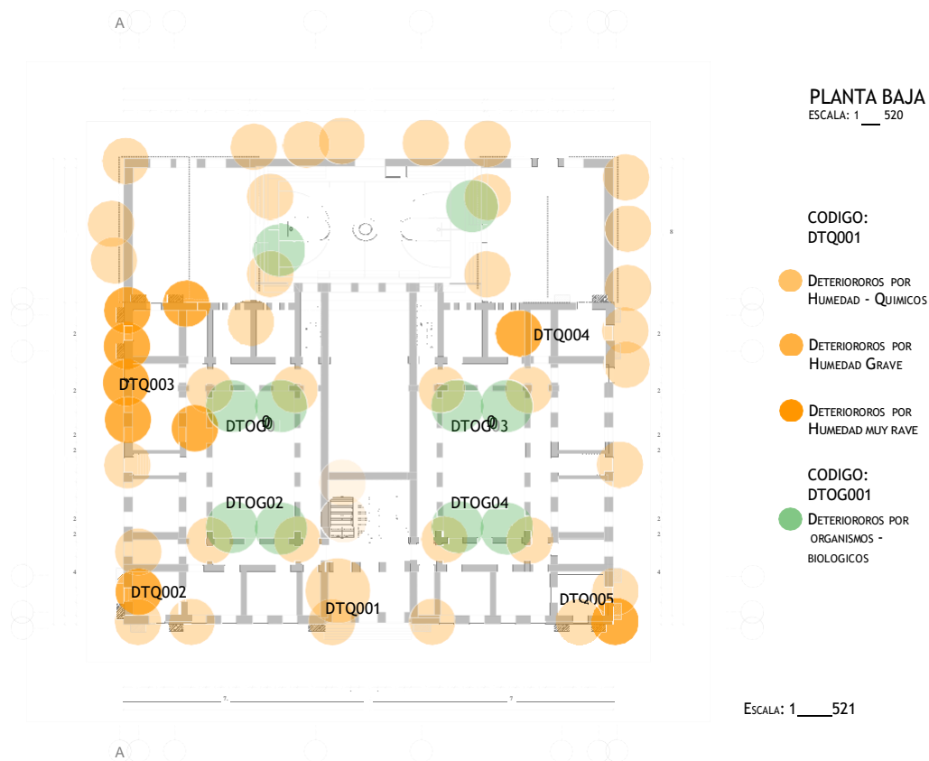
Ilustración. 24. Señalar patologías en el plano arquitectónico
