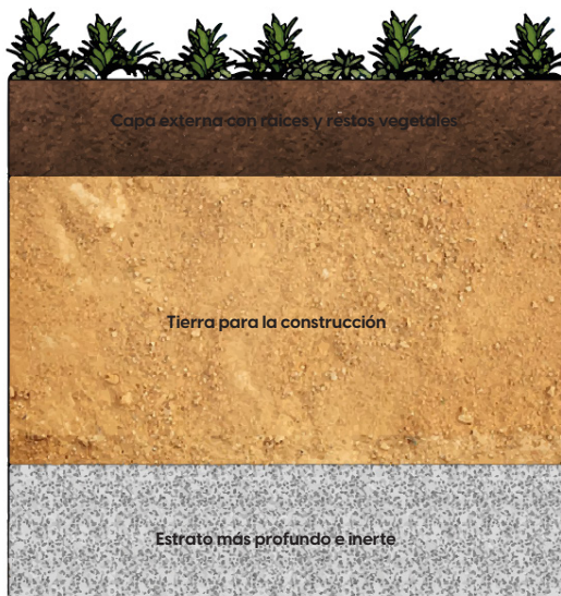
Figura 11. Tierra para la construcción
