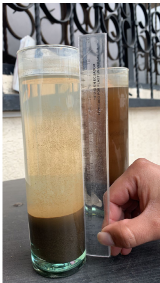
Figura 13. Prueba de sedimentación
