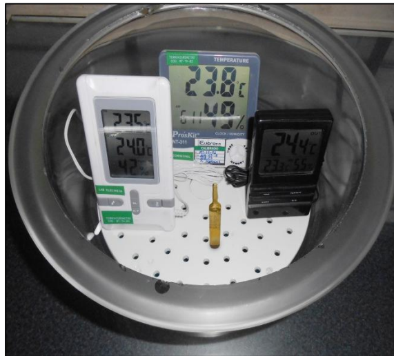
Colocación del estándar de humedad en el desecador para calibración a 60%HR
