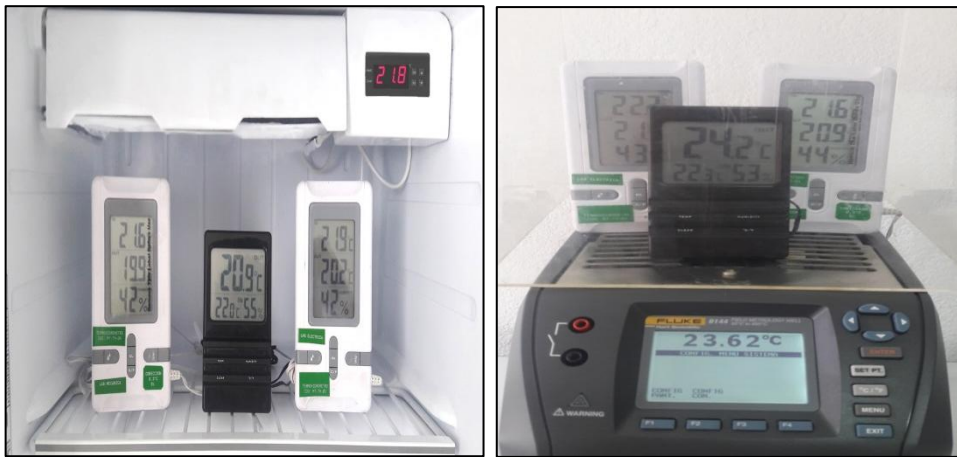
Figura N° 59: Proceso de calibración actual en temperatura.
