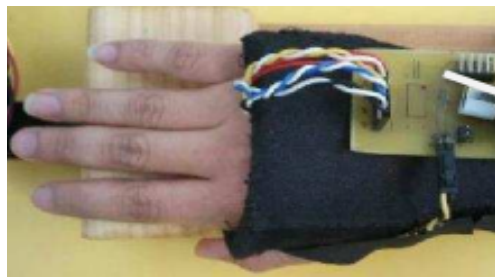
Figura 3 Sistema vibrotáctil Fuente. Adaptado de Diseño y desarrollo de un sistema vibratorio en un robot planar, 2017, ( https://www.researchgate.net/publication/262143977_Diseño_y_desarrollo_de_un_sistema_vibrotáctil_utilizado_en_un_robot_planar_para_la_rehabilitación_de_las_extremidades_superiores ).
