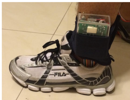
Figura 7 Sistema vibratorio Fuente. Adaptado de Escuela Politécnica Litoral, Diseño, construcción evaluación de dispositivos de estimulación vibro táctil en extremidades inferiores, ( http://www.dspace.espol.edu.ec/handle/123456789/41808?locale=es )
