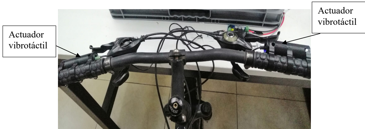
Figura 29 Volante con actuadores vibro táctiles Fuente. Se indica la posición donde están ubicados los actuadores vibrotáctiles, elaborado por el autor.
