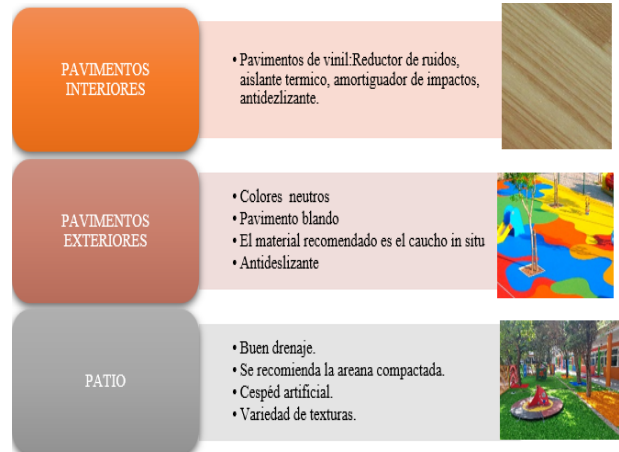
Figura 10: Pavimentos recomendados para guarderías Fuente: Elaboración Propia, 2022.
