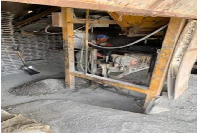
Gráfico 12. Vibro Prensadora con el material por un minuto la elaboración del bloque Fabrica Concrete Block.
