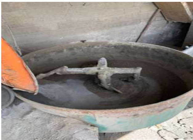
Gráfico 10. Mezcla del Material agregados Polvo, Chispa, Cemento Fabrica Concrete Block. Fuente: Elaboración propia
