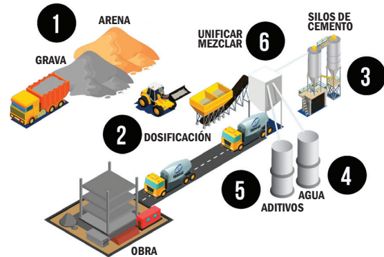
Fig.10. Proceso y elaboración del Hormigón Fuente: Elaboración propia
