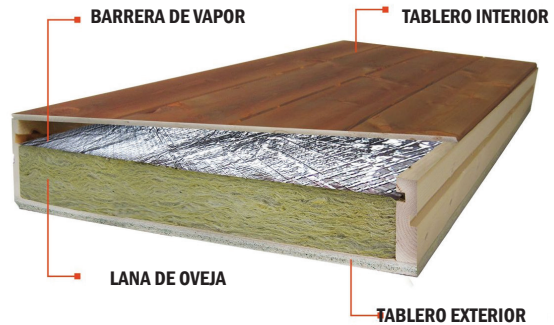
Fig.28. Detalle constructivo de la lana de oveja Fuente: IBR para sandwich in situ, 2018
