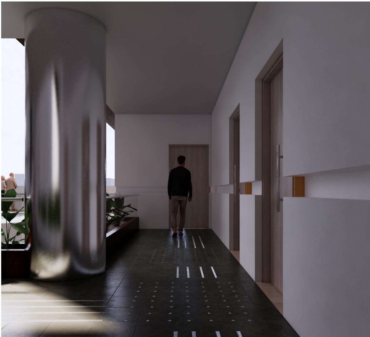
Fig. 108. Paillos adecuado con las señalizaciones podotactiles.
