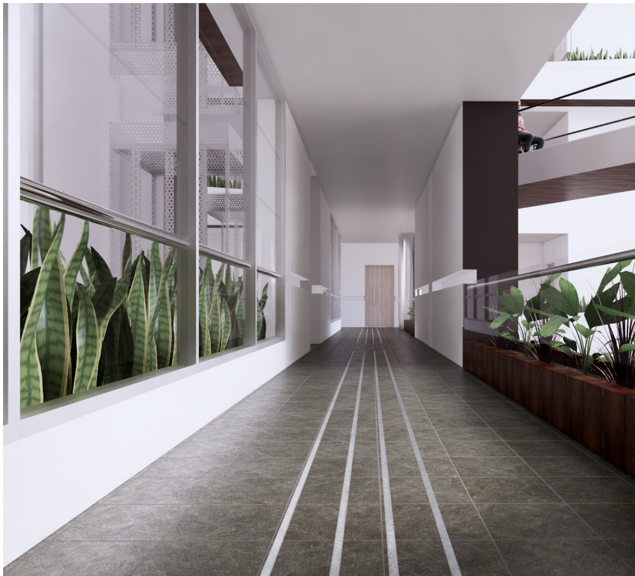
Fig. 110. Pasillos adecuado con señalizaciones podotactiles.
