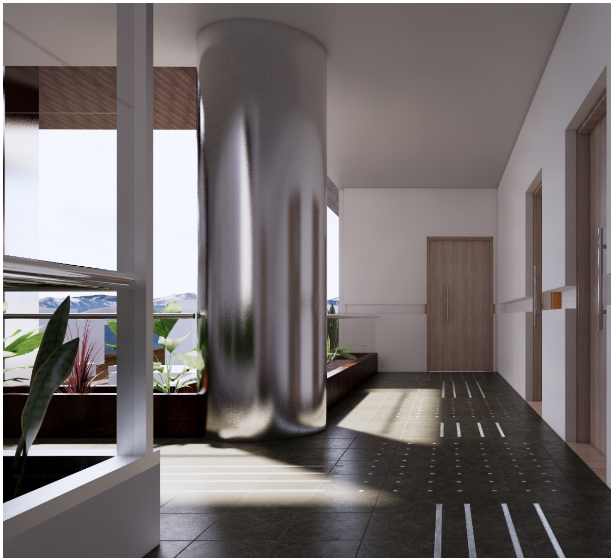
Fig. 109. Paillos adecuado con señalizaciones podotactiles.
