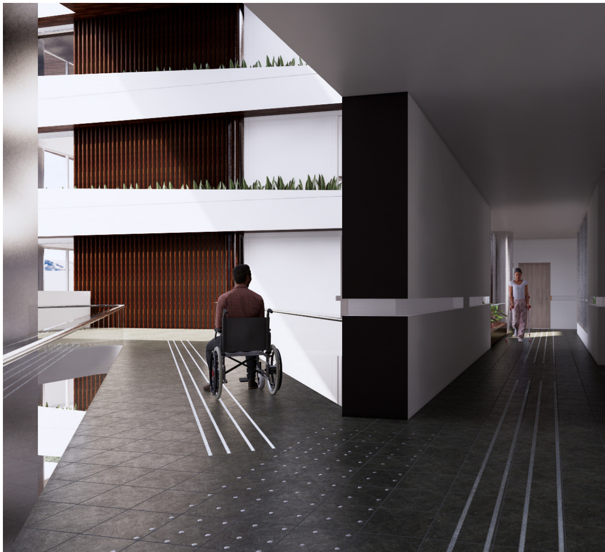
Fig. 111. Conexión entre Pasillos y terrazas, adecuado con señalizaciones podotáctiles.
