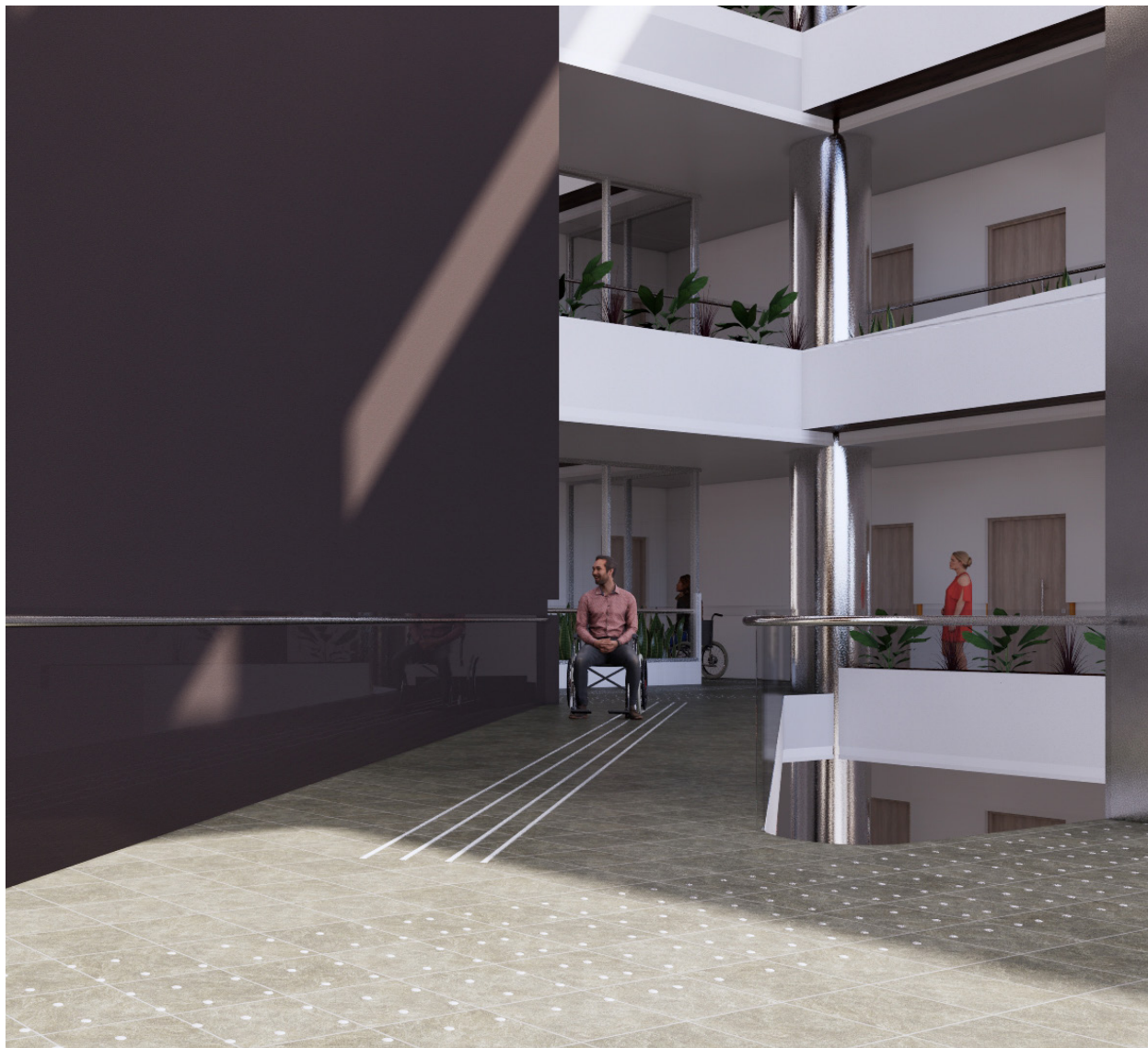
Fig. 112. Conexión entre Pasillos y terrazas, adecuado con señalizaciones podotactiles.
